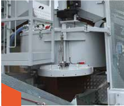
6 Une trappe de vidange dans le malaxeur
