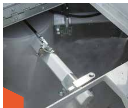
1 Lavage automatique du malaxeur à l'eau haute pression
