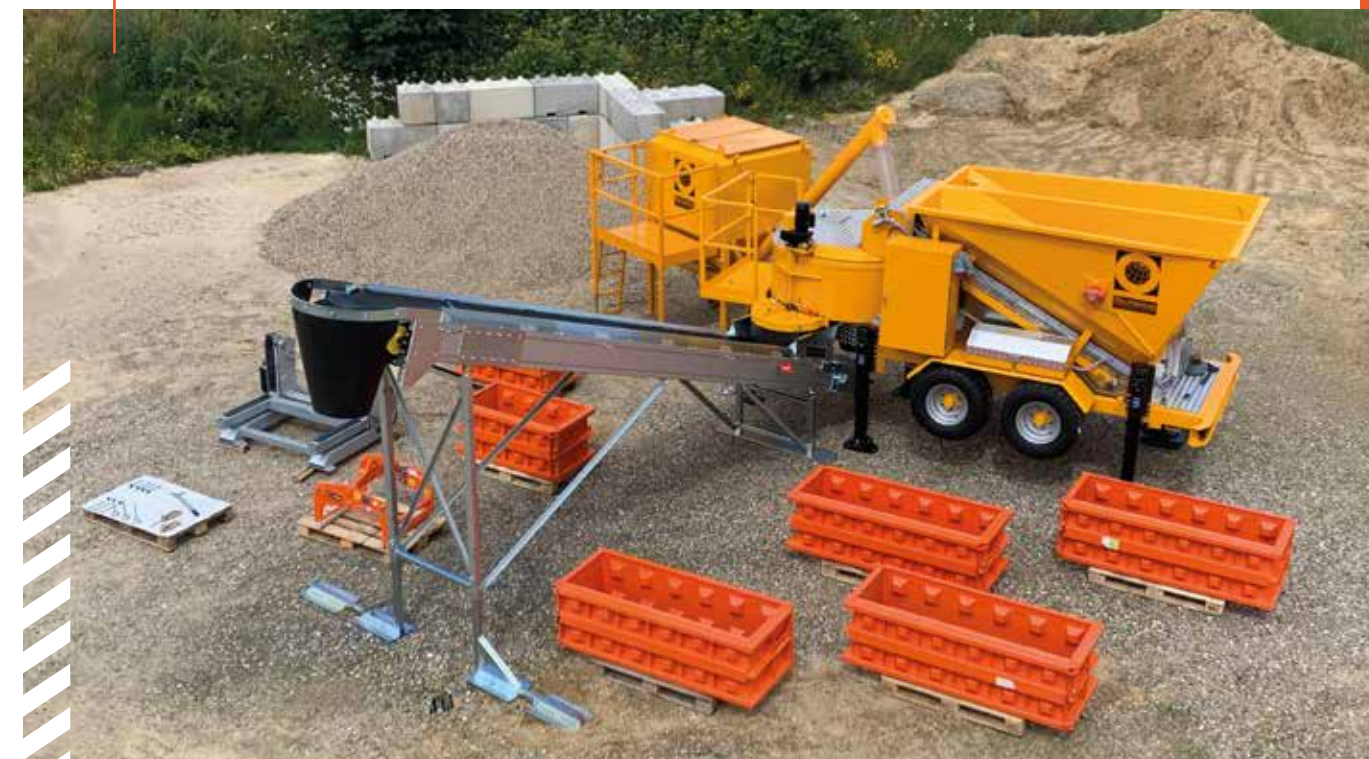
Fabrication de blocs béton
