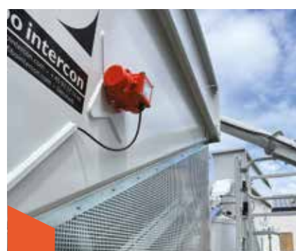
9 Moteur vibrant sur les trémies
