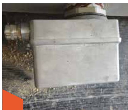
5 Chauffe-eau pour le réservoir d'eau
