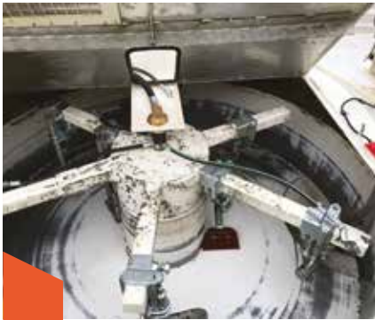
2 Malaxeur planétaire en Hardox. Tôles d'usure boulonnées sur le modèle 1800 et 2200
