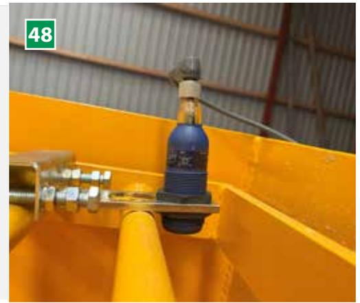
**48 Capteur de niveau pour les pompes à béton (en option)**
