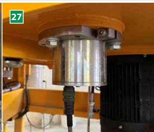
**25 Capteur d'humidité pour le mélangeur (en option)**
