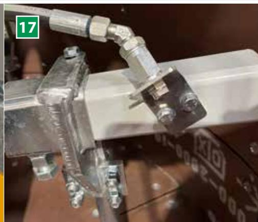
**17 Nettoyage semi-automatique à haute pression (en option)**
