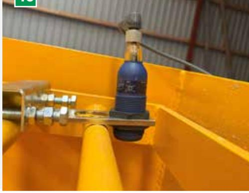
**46 Capteur de niveau pour les pompes à béton (en option)**
